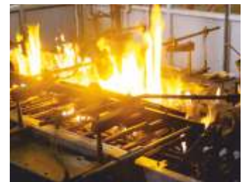
BEAKER MACHINE : 6000 pcs per shift
